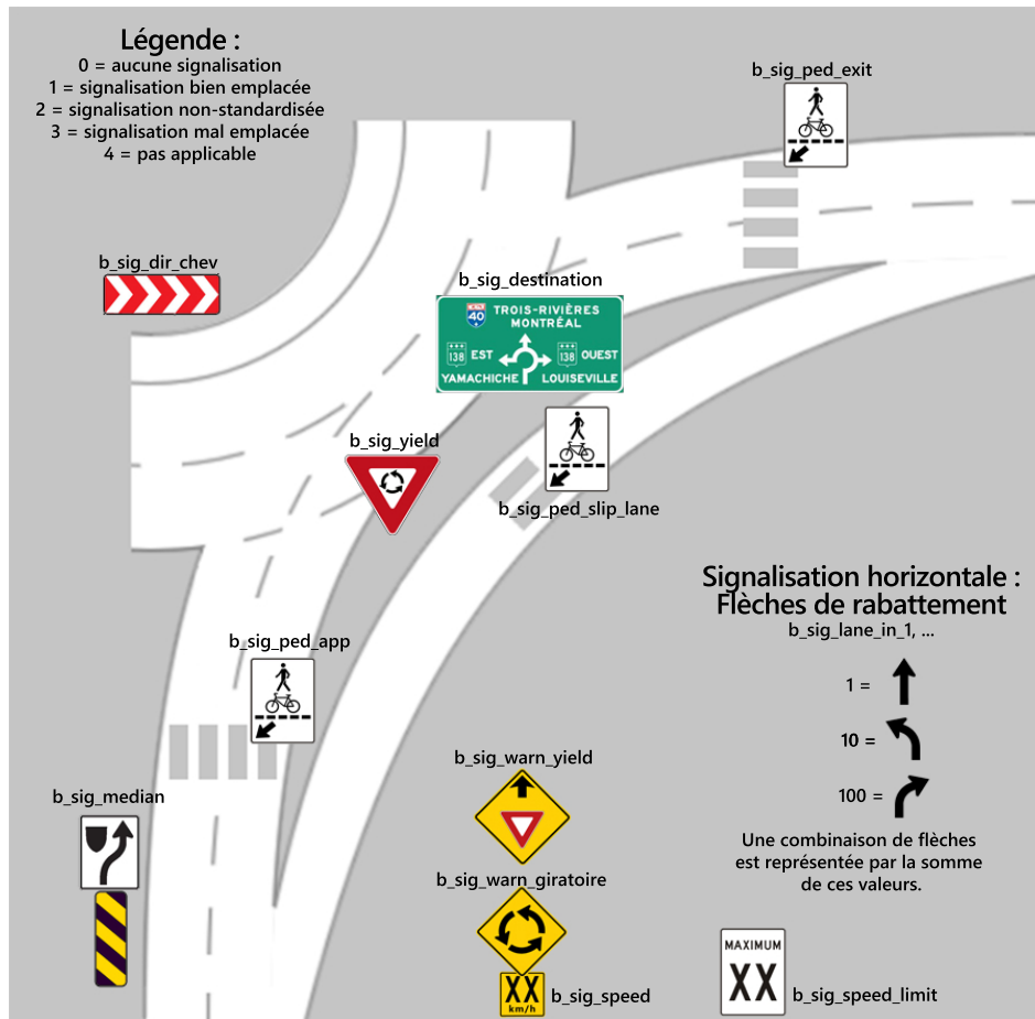
FIGURE 7 – Schéma des caractéristiques de la signalisation sur un quadrant
