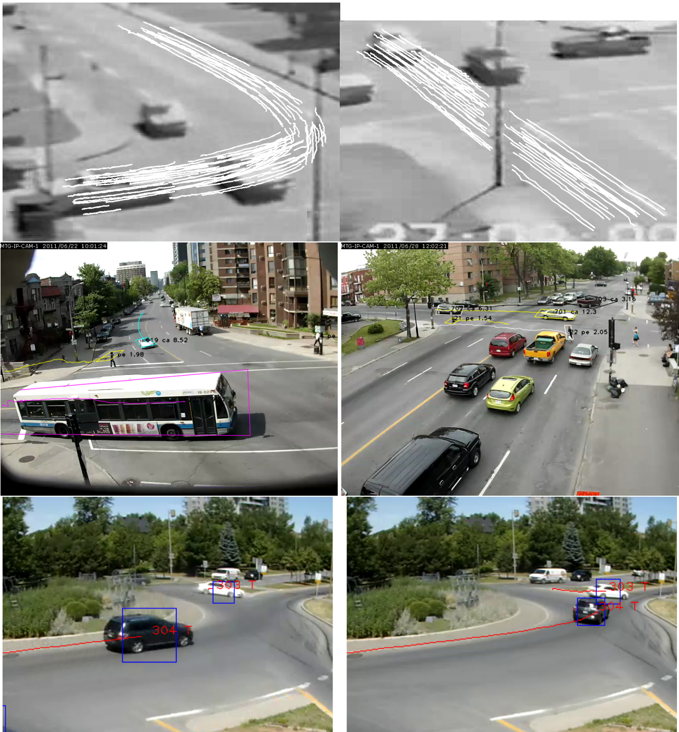
FIGURE 14 – Exemples de suivi d’usagers de la route dans différents contextes et études (images en haut tirées de [71], au milieu de [7] et en bas sur un carrefour giratoire de l’étude, de [77])
