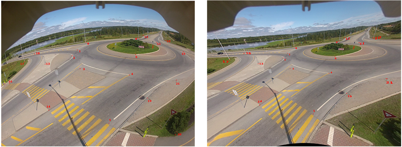
FIGURE 15 – Exemple de prise de vue par une caméra avec objectif hypergone et de correction par le logiciel d’analyse vidéo
